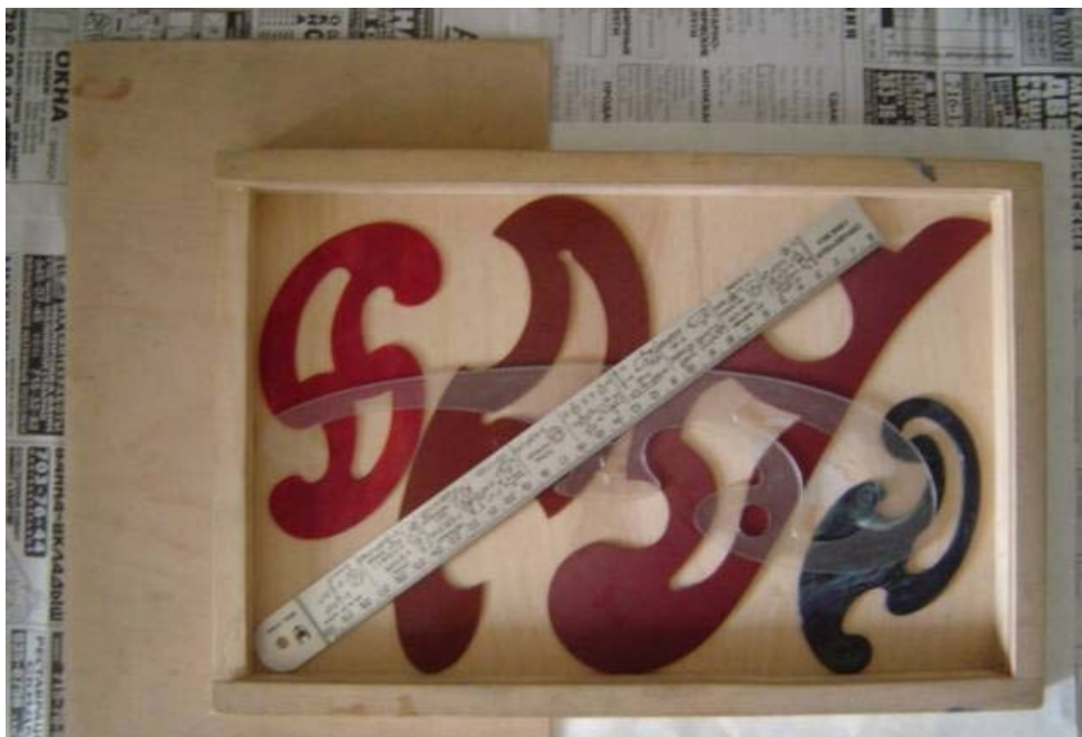
Рис. 1. Школьные чертежные доски: а – рабочее место с регулируемым наклоном доски; б – разборная чертежная доска; в – переносная чертежная доска формата А4 с набором лекал
