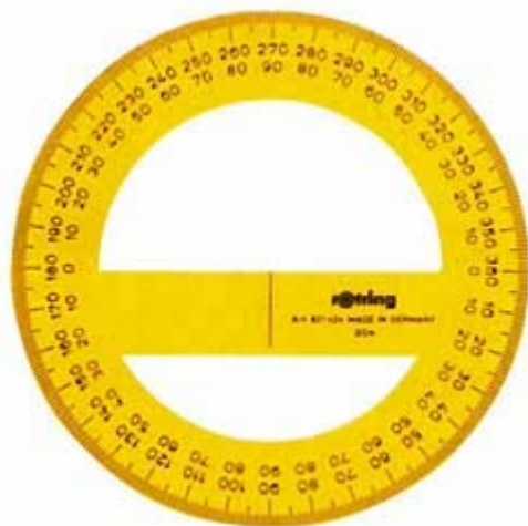
Рис. 7. Транспортиры: а – на 180^{\circ} ; б – на 360^{\circ}
