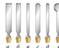
Рис. 4.26. Резцы-стамески: а, б, в — плоские; г, д — скрученные; е — стамеска-крючок
