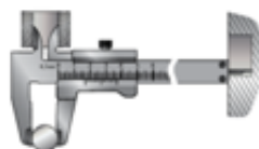
Рис. 4.16. Приёмы измерения штангенциркулем
