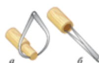
Рис. 4.17. Приёмы измерения: а — наружного размера — кронциркулем; б — внутреннего размера — нутромером
